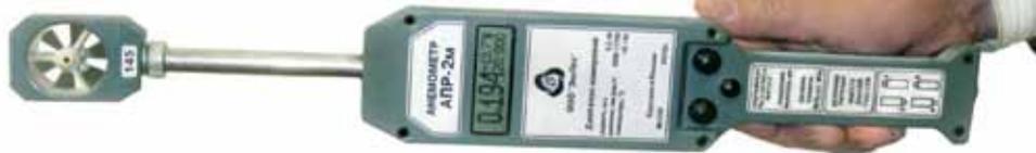
Рис. 1. Анемометр рудничный АПР-2м
